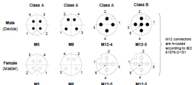
**Port Class A (Typ A):** Bei diesem Typ sind die Funktionen der Pins 2 und 5 nicht vorgegeben. Diese Funktionen definiert der Hersteller. Pin 2 kann mit einem zusätzlichen Digitalkanal belegt werden.
